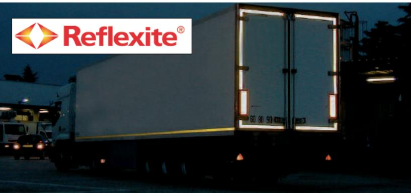
Ces marquages rétro-réfléchissants permettent aux automobilistes un temps supplémentaire de réaction à l'approche des poids lourds la nuit ou dans de mauvaises conditions de visibilité
